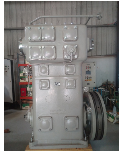
Vollständig überholter Laby®-Kompressor, bereit für den Einsatz bei der Dampfückgewinnung.
